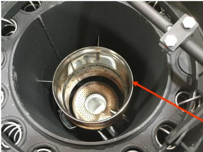
Wkład komory spalania ze stali szlachetnej 1.4571
